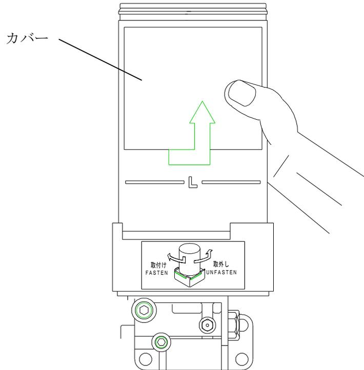
2) 空のカートリッジを反時計回りに回して取り外します。
