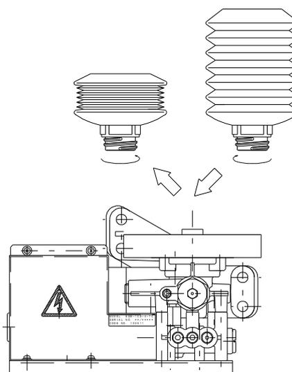
3) 空になったカートリッジをポンプから外し、新しいカートリッジを取付ける。取付けの際、カートリッジのグリースを少量出してから取付ける。
