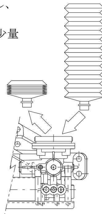
3) カバーを再びポンプに取り付け、素手でしっかりと締め付ける。(シールが正面になる位置)
