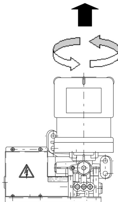
2) 空のカートリッジを反時計回りに回して取り外します。
