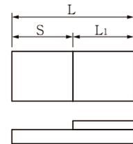
グリース接触面積(ベアリングのみ投影面積)に8時間にて0.005cm(50μ)の油膜のグリースが消費される事を基準とする。
